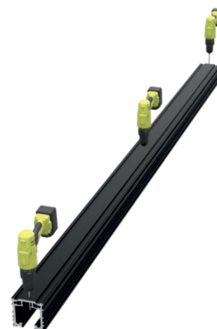
Рис. 1 Засверловка отверстий в верхнем треке
