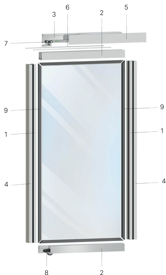
Рис. 23 Сборочная схема (взрыв-вид) раздвижной системы
