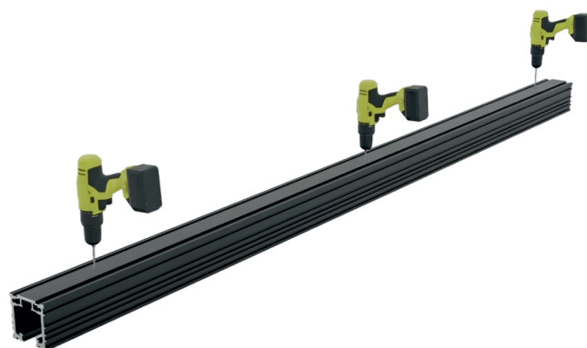
Рис 3. Засверловка отверстий в верхнем треке
