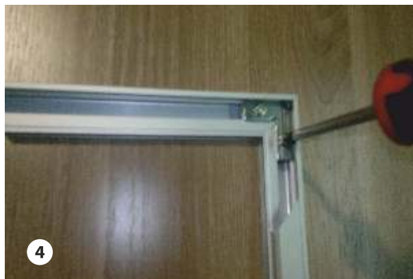
Установить уплотнитель, стекло. Затянуть сборочные уголки, не допуская образования щелей по углам фасада.
