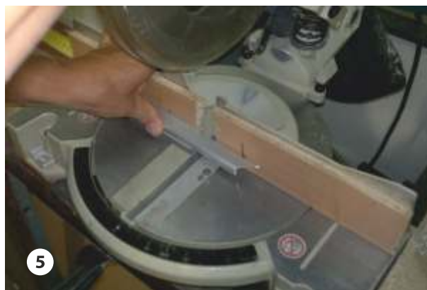
Нарезать крышку на стороны, в которых установлены петли и адаптер.
