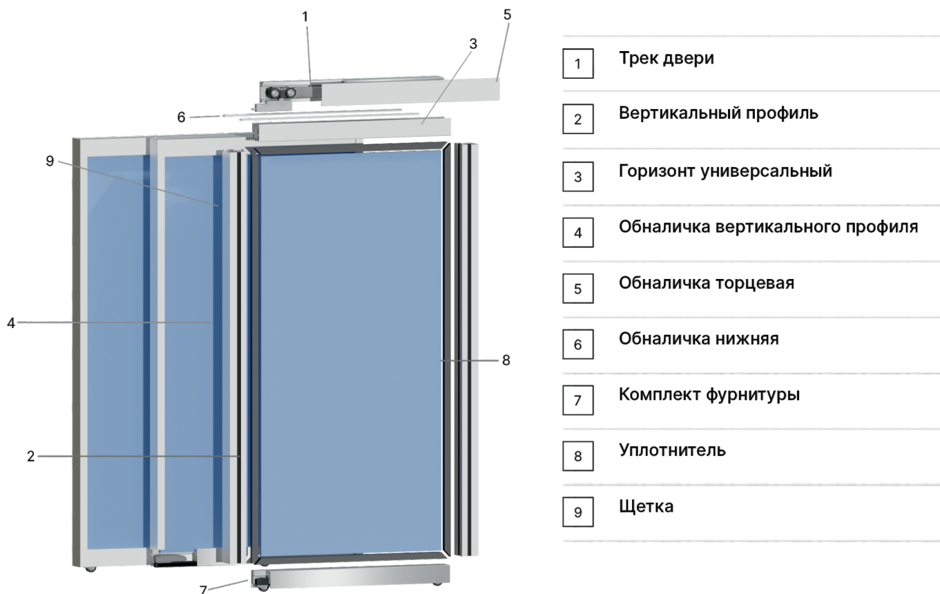
Рис 33. Сборочная схема (взрыв-вид) раздвижной системы
