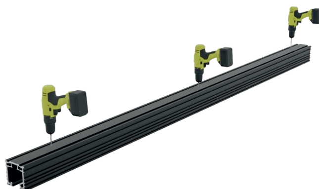
Рис 3. Засверловка отверстий в верхнем треке
